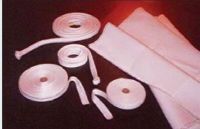
세라믹 섬유 실에 유리 섬유 또는 Sus Wire를 보강하여 여러 종류의 천 형태로 만든 제품. 실리콘, 질석 등으로 코팅한 제품과 Sintering 처리한 제품등 다양한 종류의 제품이 있다.
